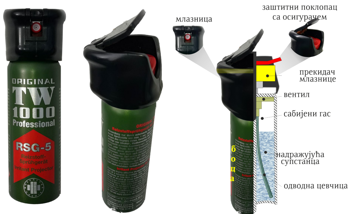
Слика 1 – Изглед и делови спреј дозе original TW1000 Profesional, RSG-5
